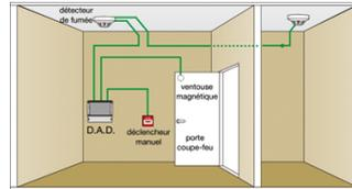
Conformément aux normes en vigueur, le DAD BC6 NF permet, par exemple, de commander la fermeture des portes CF de communication entre la surface de vente et les réserves de magasins.
